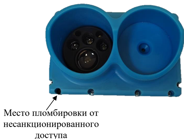
Рисунок 1 – Внешний вид передней панели изделия, место пломбировки от несанкционированного доступа
