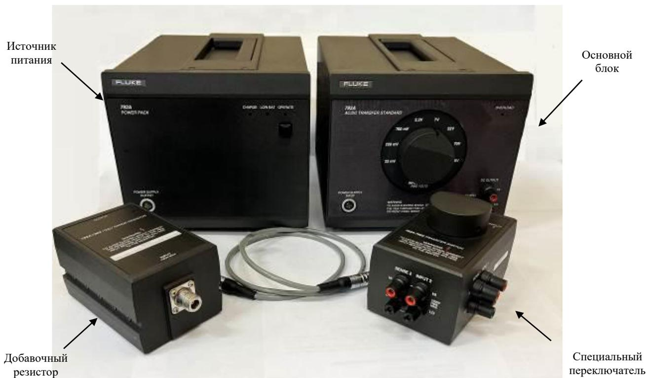
Рисунок 1 – Общий вид преобразователя переменного напряжения 792А
