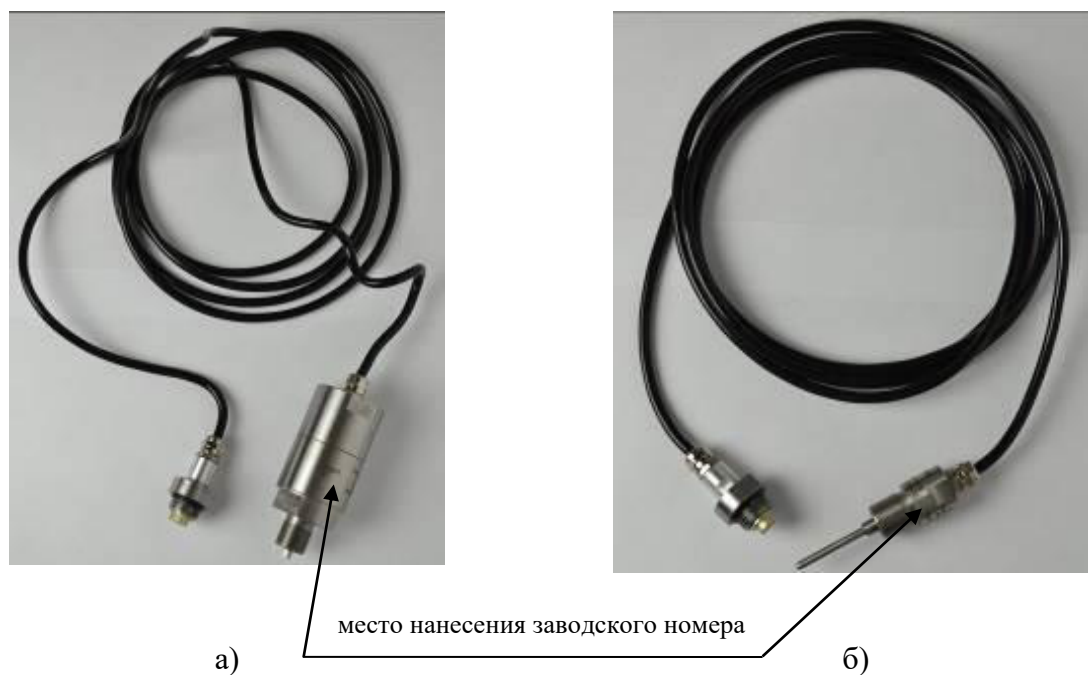
Рисунок 2 – Общий вид выносных датчиков а) датчик давления выносной; б) датчик температуры выносной
