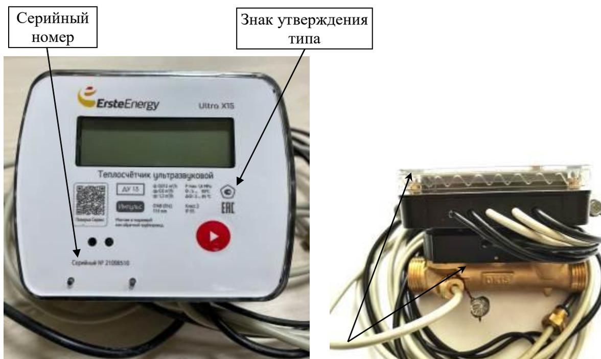
Место для пломбирования поверителем от несанкционированного доступа, обозначение места нанесения знака поверки (пломбы поверителя) на теплосчетчик
