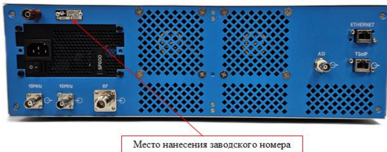
Рисунок 3 – Задняя панель корпуса демодулятора телевизионного цифрового измерительного ДТЦ-5И
