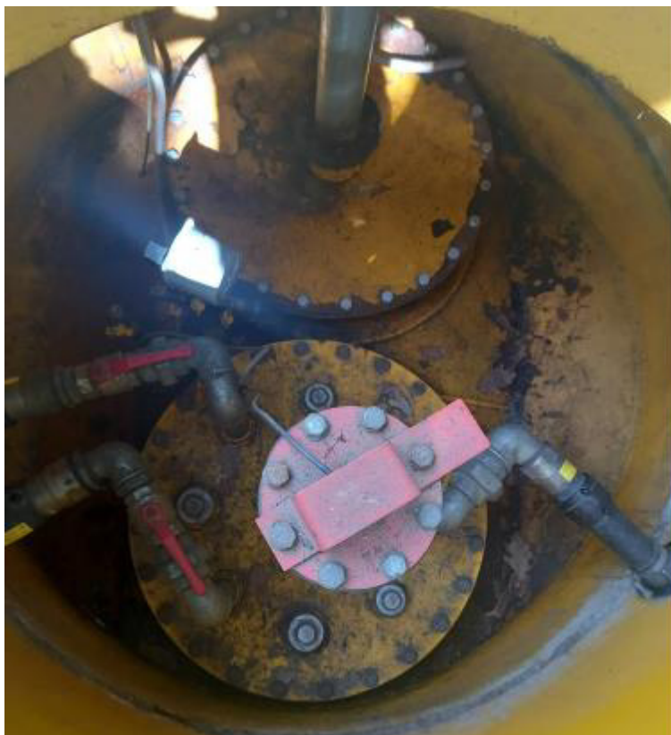
Рисунок 4 – Маркировочная табличка и горловины резервуара РТ 37 зав.№ 373/37
