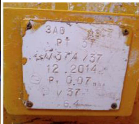
Рисунок 5 – Маркировочная табличка и горловины резервуара РТ 37 зав.№ 374/37
