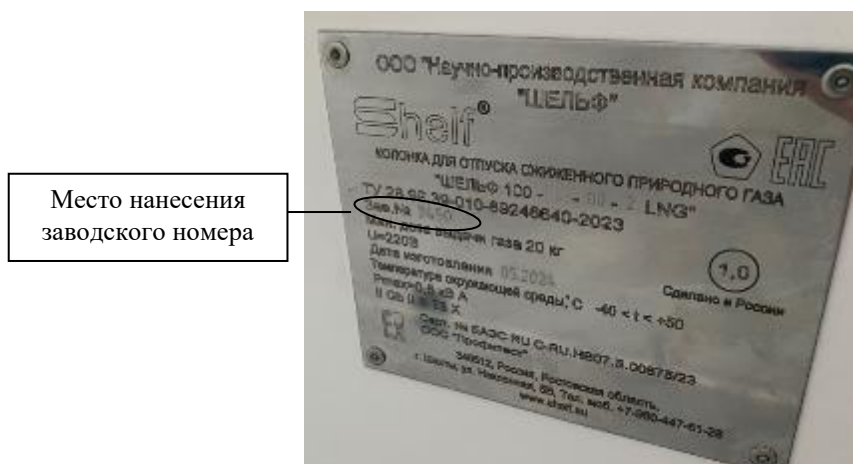
Рисунок 3 – Место нанесения заводского номера
