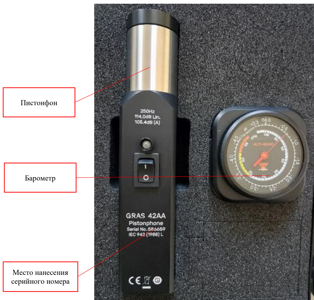
Рисунок 1 – Общий вид пистонфона
