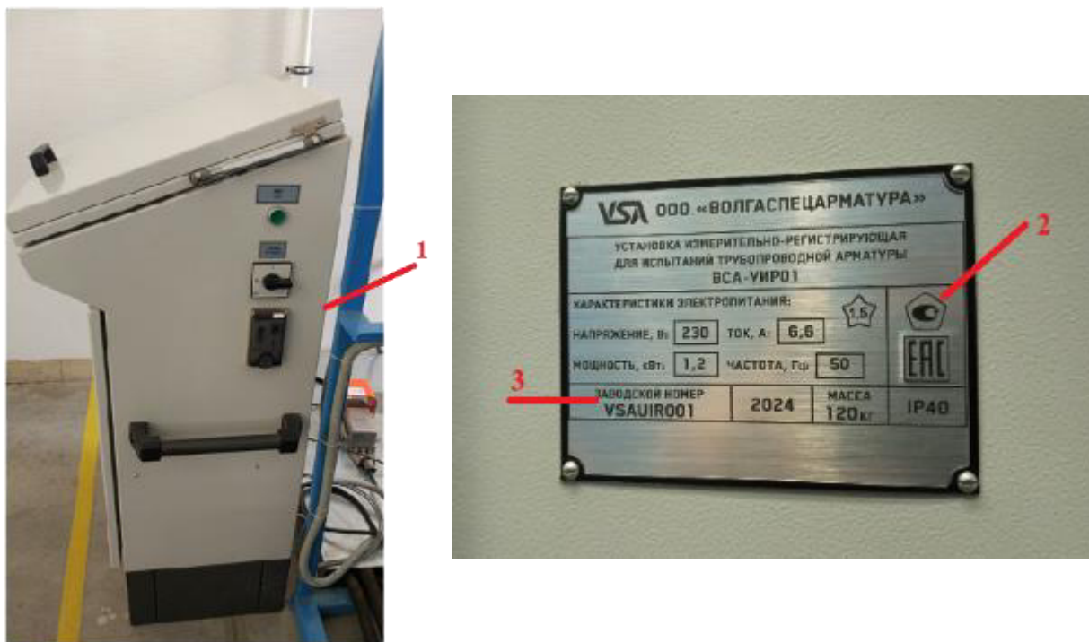
Рисунок 2 – Место нанесения маркировочной таблички (1) и места нанесений заводского номера (3) и знака утверждения типа (2) на установке измерительно-регистрирующей для испытаний трубопроводной арматуры ВСА-УИР01, зав.№ VSAUIR001
