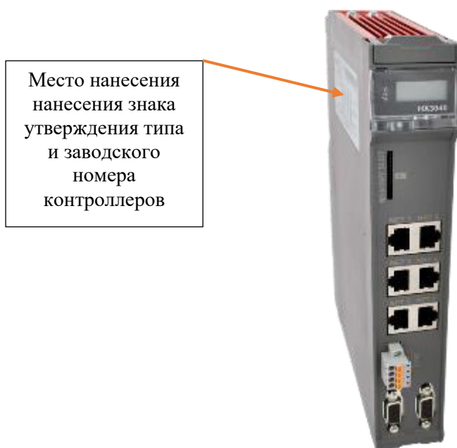
Рисунок 3 – Общий вид модуля центрального процессора с указанием места нанесения знака утверждения типа и заводского номера контроллеров
