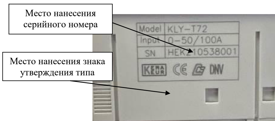
Рисунок 2 – Место нанесения знака утверждения типа и место нанесения серийного номера
