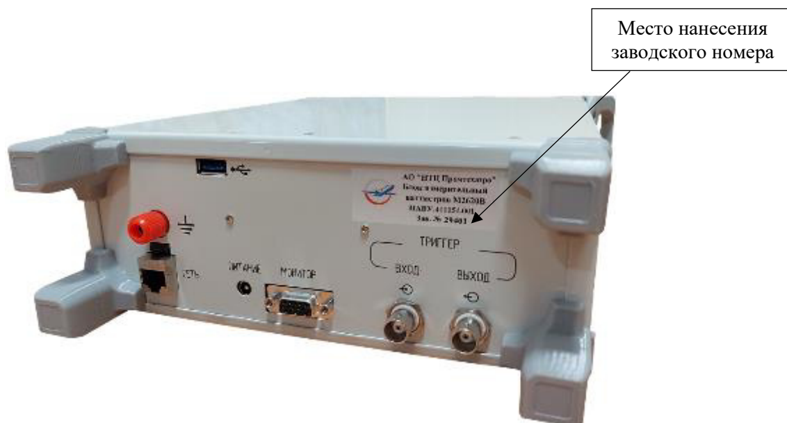
Рисунок 2 – Внешний вид задней панели блоков измерительных ваттметров M2620B с указанием места нанесения заводского номера
