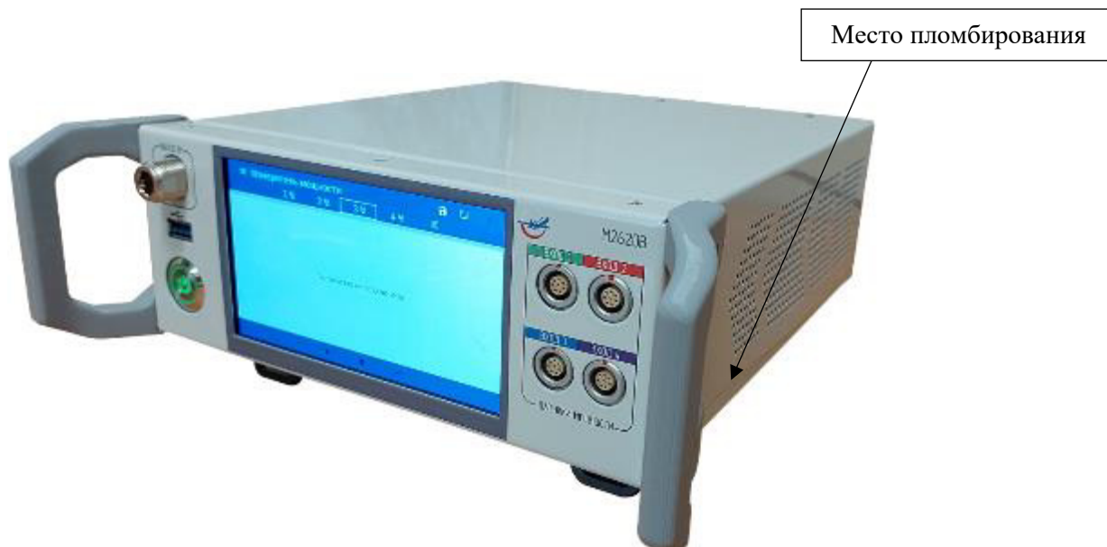
Рисунок 1 – Внешний вид блоков измерительных ваттметров M2620B с указанием места пломбирования от несанкционированного доступа
