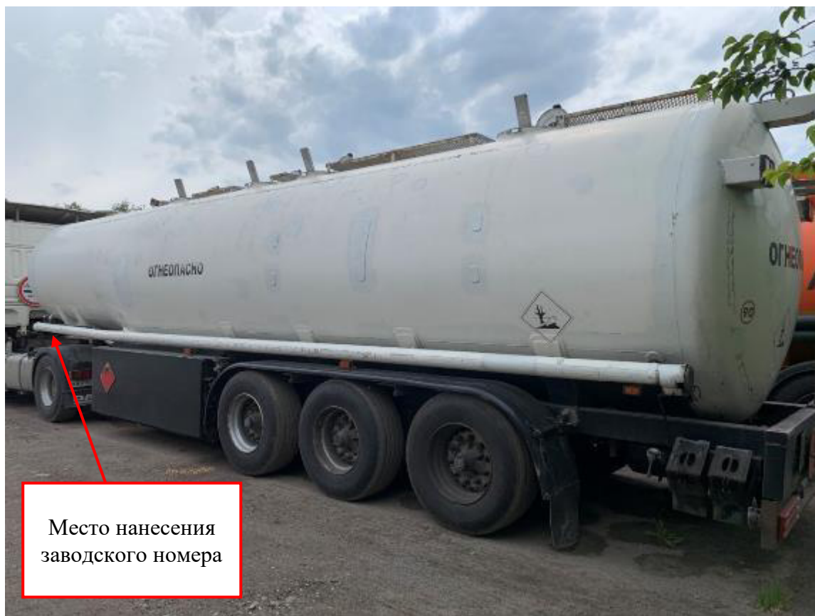
Рисунок 1 – Общий вид полуприцепа-цистерны ROHR TAL-A-MKZA 42.8 с указанием места расположения заводского номера
