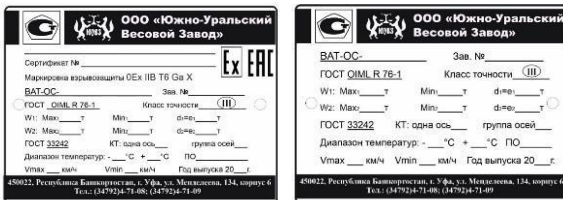
Рисунок 4 – Общий вид маркировочной таблички для модификаций во взрывозащищенном исполнении (слева) и для модификаций, выполненных не во взрывозащищенном исполнении (справа)
