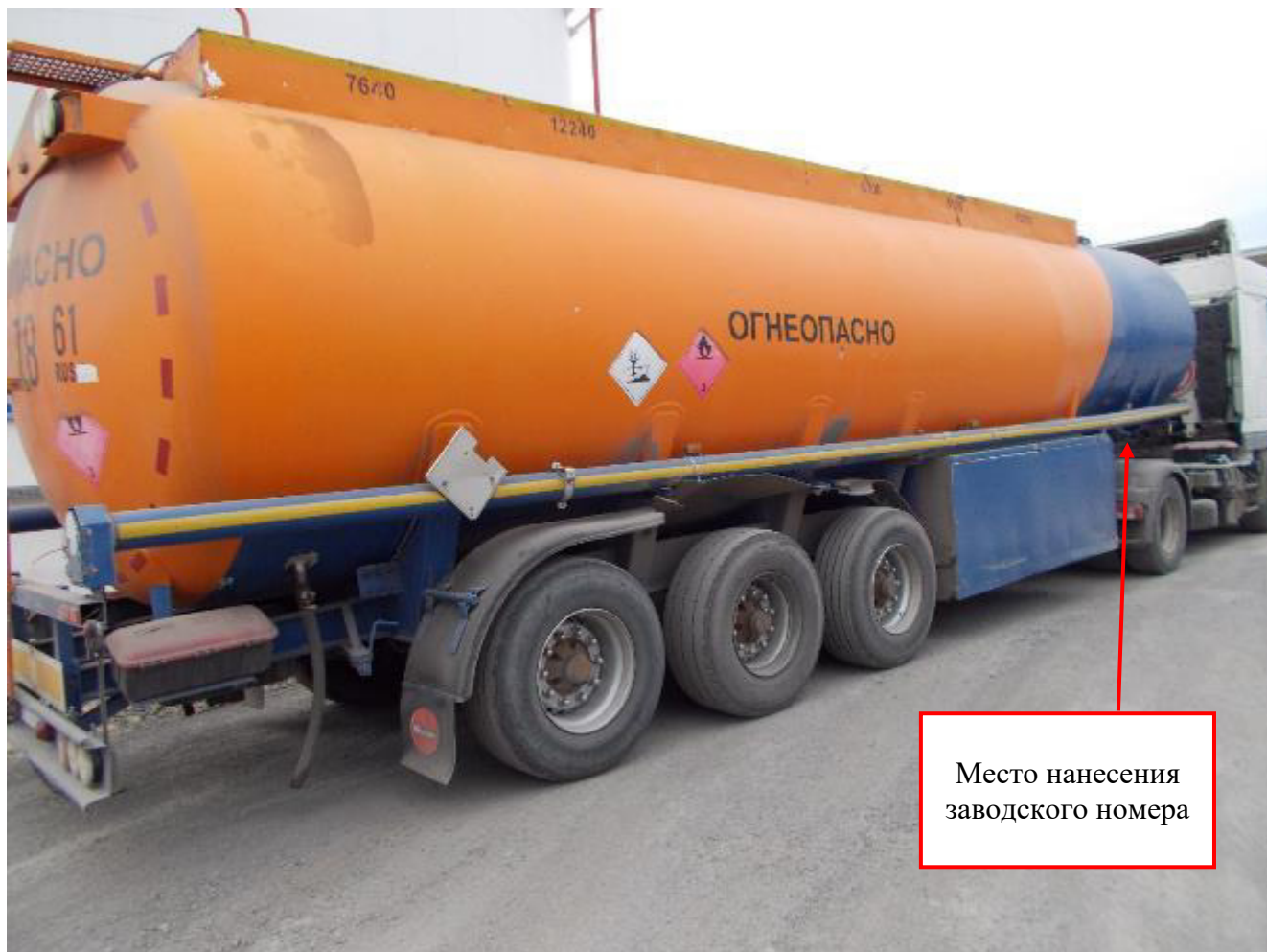
Рисунок 1 – Общий вид полуприцепа-цистерны WILLING SANA 44.0 с заводским номером W09068334T1W20005 с указанием места нанесения заводского номера
