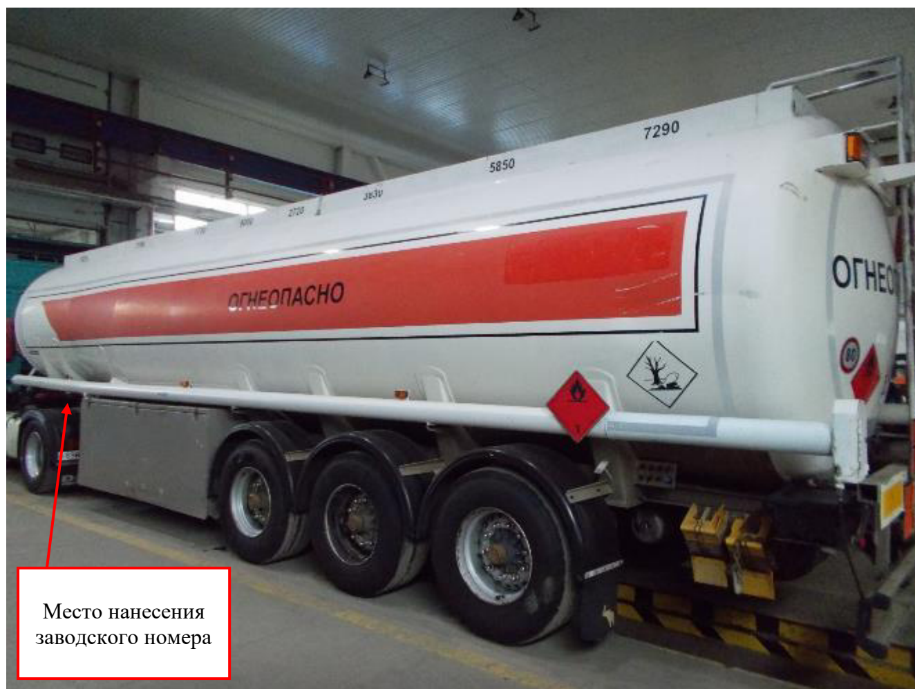
Рисунок 2 – Общий вид полуприцепа-цистерны WILLING SANZ 41.4 с заводским номером W09117334X1W20051 с указанием места нанесения заводского номера
