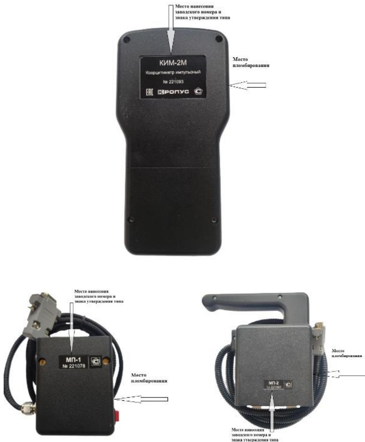
Рисунок 4 – Место нанесения заводского номера, знака утверждения типа и пломбировки от несанкционированного доступа на электронном блоке коэрцитиметров и преобразователях
