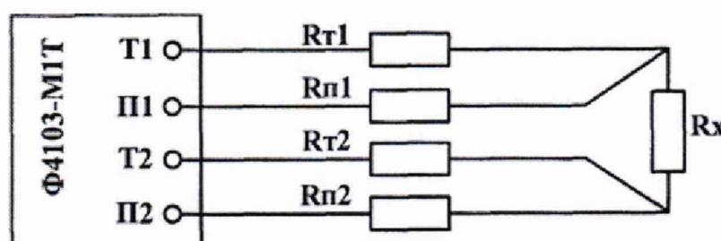
Рисунок 1 – Схема определения основной приведенной к верхнему пределу диапазона измерений погрешности измерений электрического сопротивления заземляющих устройств
