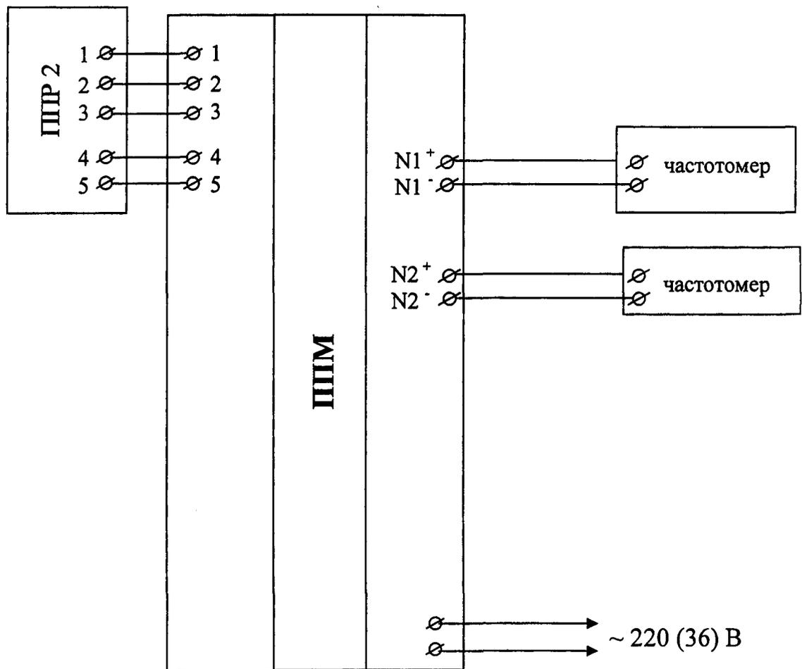
Рисунок А.4 - Схема подключения расходомеров модификаций РСМ-05.07 и РСМ-05.07М
