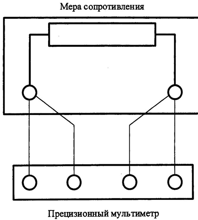
Рисунок А.4 - Схема подключения прецизионного мультиметра
