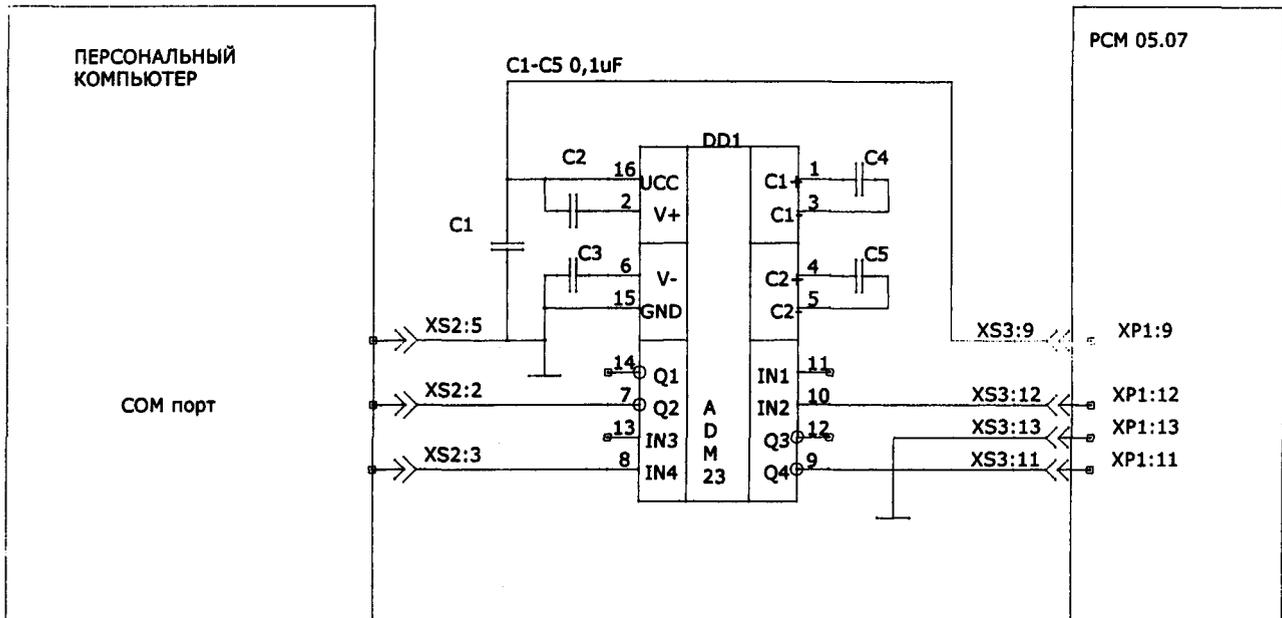
Рисунок Б.1 - Принципиальная электрическая схема преобразователя RS-232C
