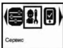
Меню ускоренного установки настроечных данных с помощью шаблонов типовых схем, выполнения функции очистки памяти, сохранение конфигурации и восстановления сохраненных конфигураций. Эти функции работы вычислителя доступны только в режиме «**Конфигурирование**».
