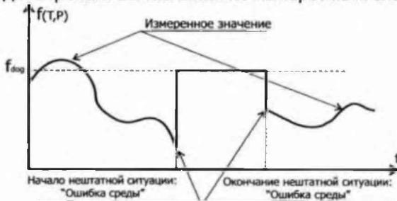
Рисунок 6.2 Работа вычислителя в режиме нештатной ситуации - «*Ошибка среды*»
