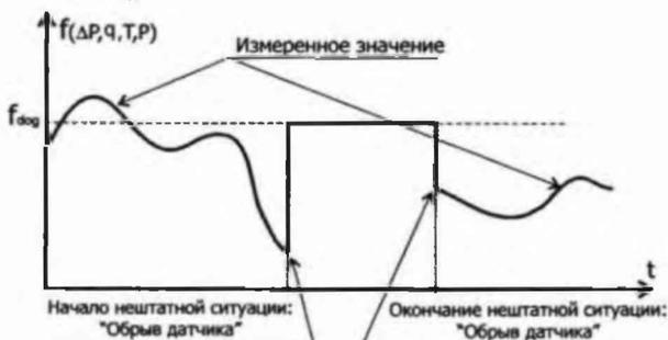
Рисунок 2.11 Работа вычислителя в режиме НС «Обрыв датчика»
