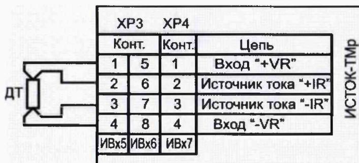
Рисунок 1.4 – Пример подключения ДТ
