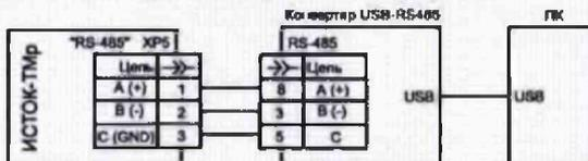
Рисунок 6.1 Схема подключения расширителя ИСТОК-ТМР к ПК
