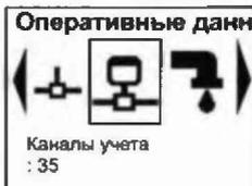
В подразделах данного меню производится добавление и удаление **КУ** (до 64), установка имени и типа именованного параметра **КУ**, установка вида представления данных, минимального и максимального значения измеряемого диапазона и договорных значений, отображения текущего значения параметра и статуса состояния активированных **КУ**. Описание пунктов меню приведено в таблице 2.3.
