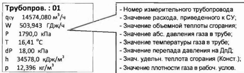
Рисунок 2.8 Пример отображения на ЖКИ вычислителя параметров измеряемой среды «Природный газ»
