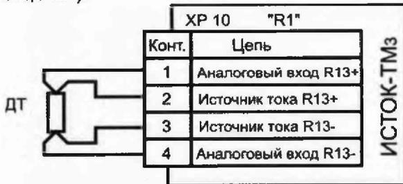
Рисунок 1.4 – Пример подключения ДТ к **ИВх «13»** вычислителя
