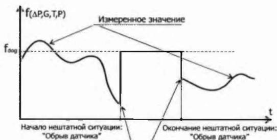
Рисунок 6.4 Работа вычислителя в режиме НС - «Обрыв датчика»
