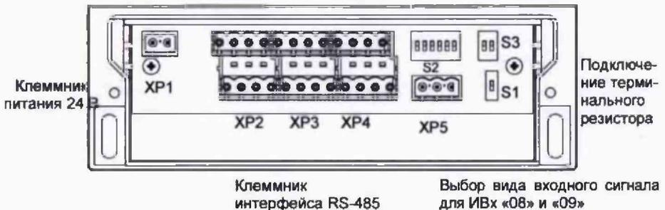
Рисунок 1.2 - Коммутационный отсек расширителя ИСТОК-ТМр
