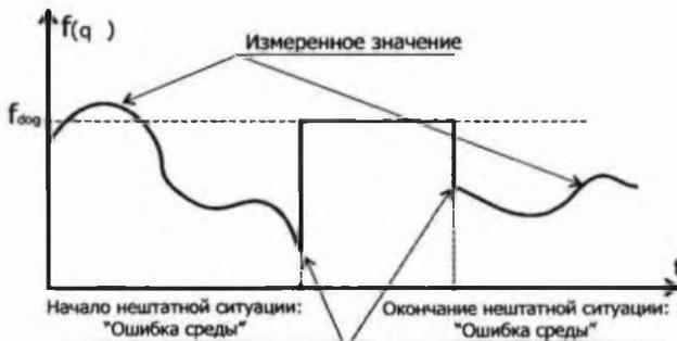
Рисунок 2.12 Работа вычислителя в режиме НС - «Ошибка среды»
