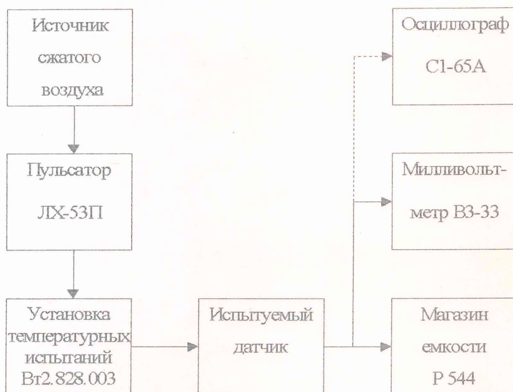
Рисунок 2 – Схема определения сопротивления изоляции и коэффициента изменения чувствительности от температуры в диапазоне температур от 25 до 200^{\circ}\text{C} .
