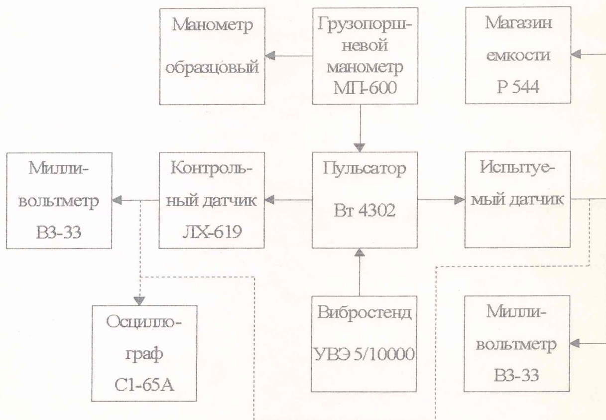
Рисунок 1 – Схема определения чувствительности
