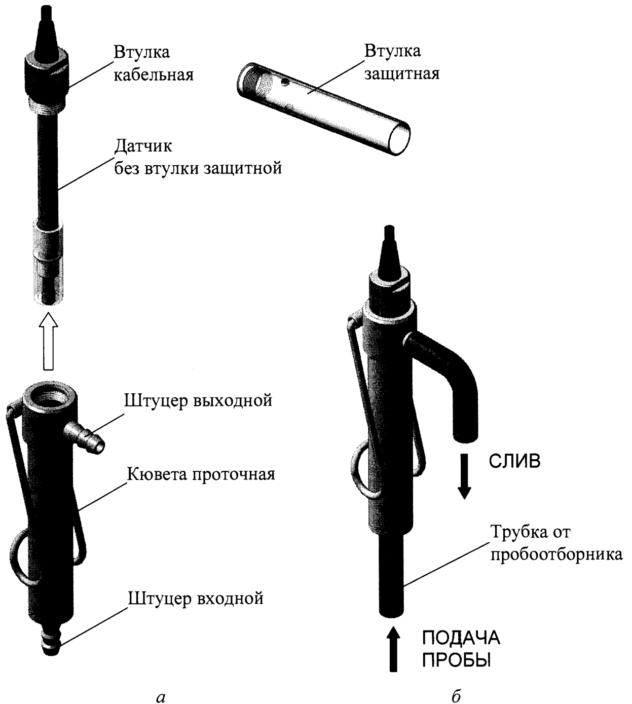
Рисунок 2.6 – Установка датчика кислородного ДК-302Т в кювету проточную
