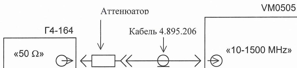
Рисунок 13.2 Схема подключения приборов для проверки погрешности амплитудных шкал.
