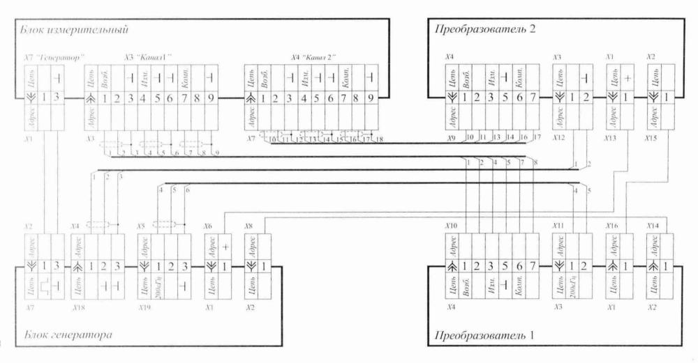
Рис. 6.1 Схема соединения блоков установки ИМПОК-1Б
