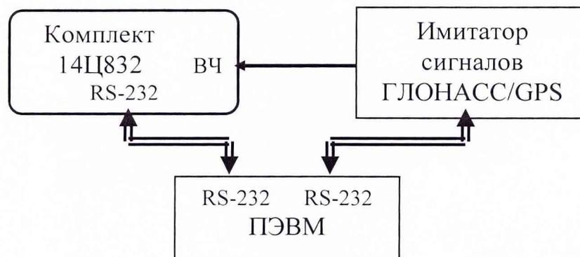
Рис.1 Схема рабочего места при использовании имитатора сигналов.
