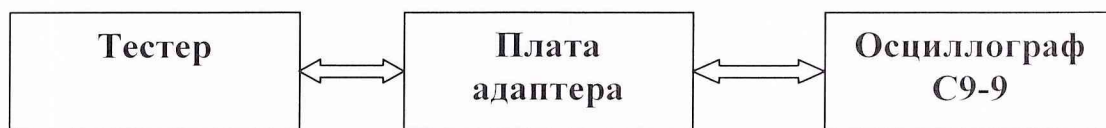
Рисунок 5. Схема поверки скорости нарастания фронта и спада среза импульса, выдаваемого тестером кодовой последовательности.
