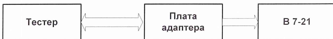
Рисунок 2. Схема поверки погрешности воспроизведения напряжения или силы постоянного тока на выводах тестера.
