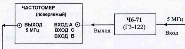
Ч6-71 – синтезатор частоты;
