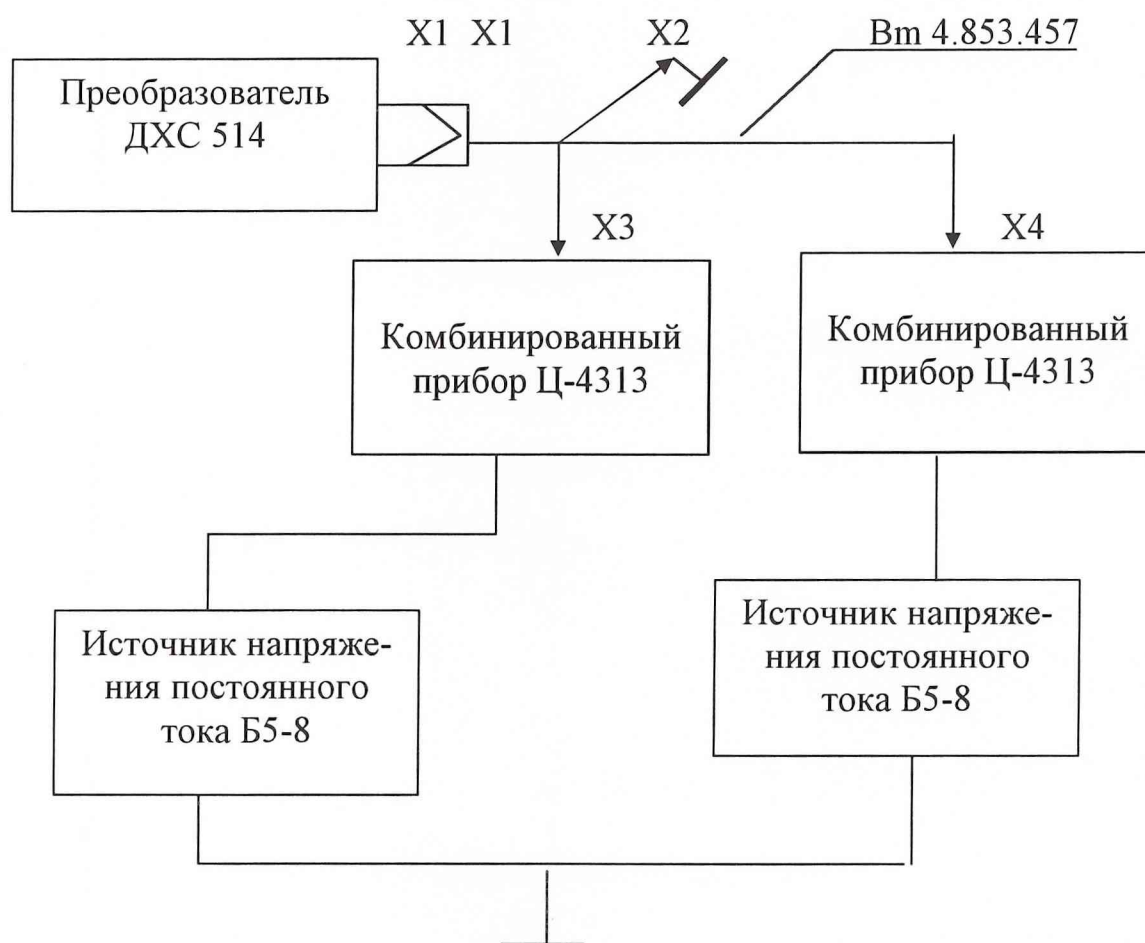
Рисунок 1 - Схема проверки тока потребления
