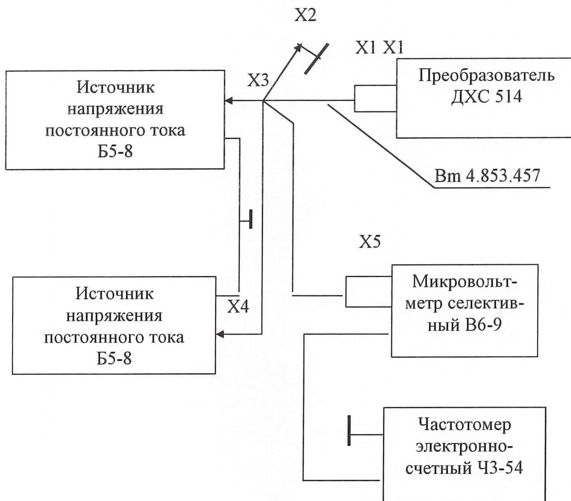
Рисунок 2 - Схема для определения амплитуды напряжения собственных шумов
