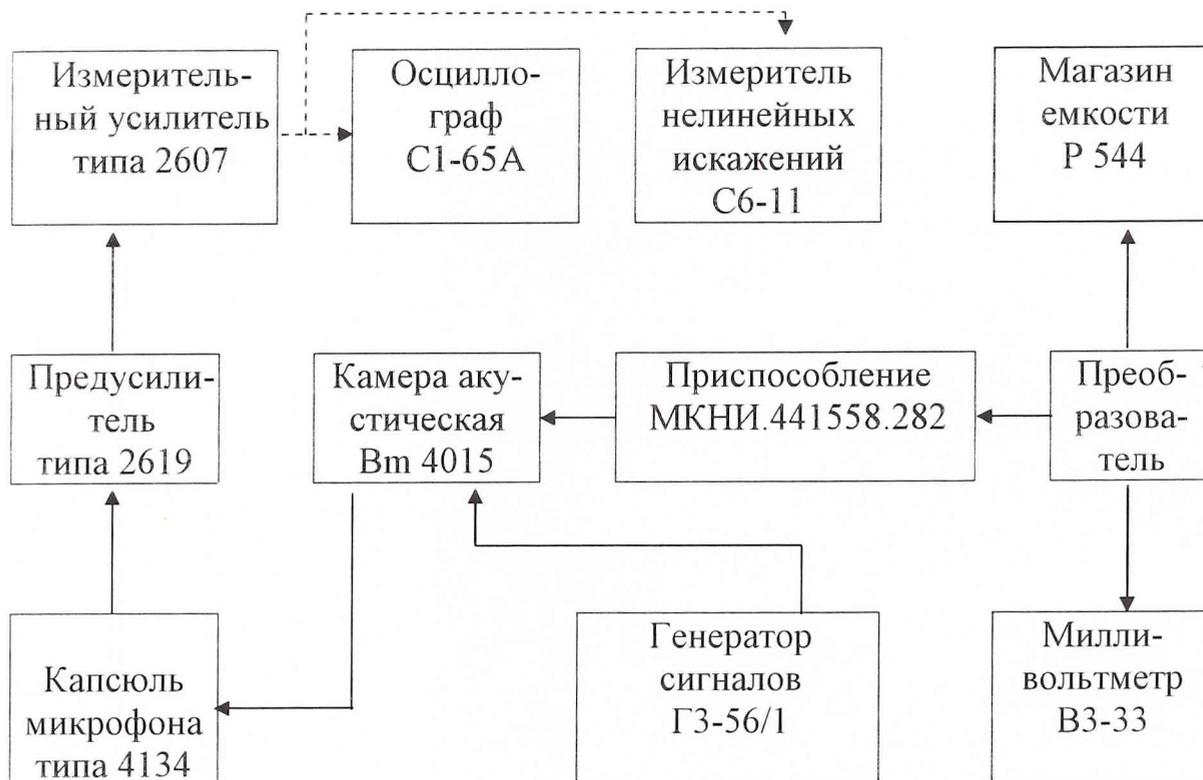
Рисунок 1 – Схема для определения коэффициента преобразования и амплитудно-частотной характеристики
