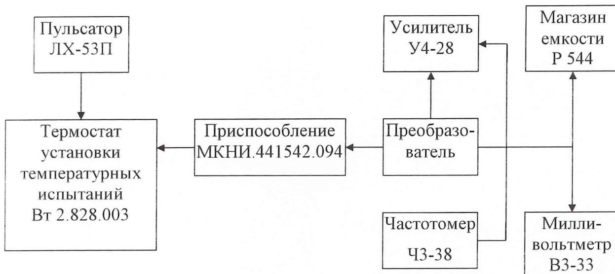
Рисунок 3 - Схема определения коэффициента изменения коэффициента преобразования преобразователя при повышенной и пониженной температурах рабочей среды
