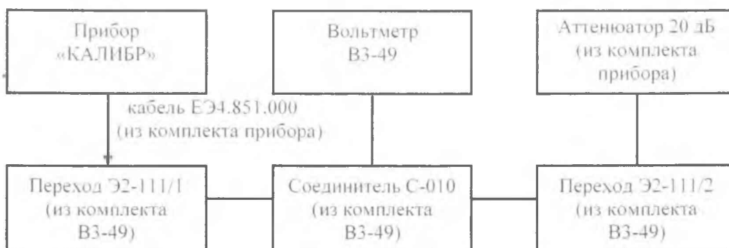
Рисунок 36 - Структурная схема соединения приборов при измерении напряжения сигнала калибратора.
