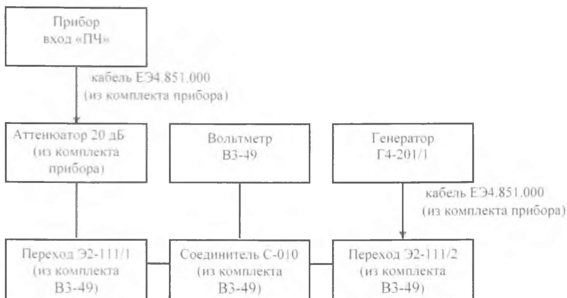
Рисунок 34 - Структурная схема соединения приборов при измерениях параметров АЧХ
