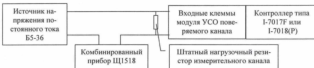
Рис.5. Схема подключения средств испытаний к ИК
