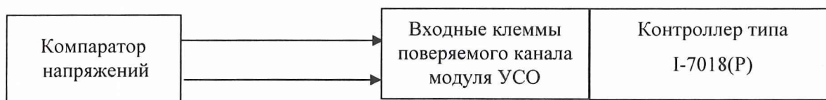
Рис.2. Схема подключения потенциометра к ИК
