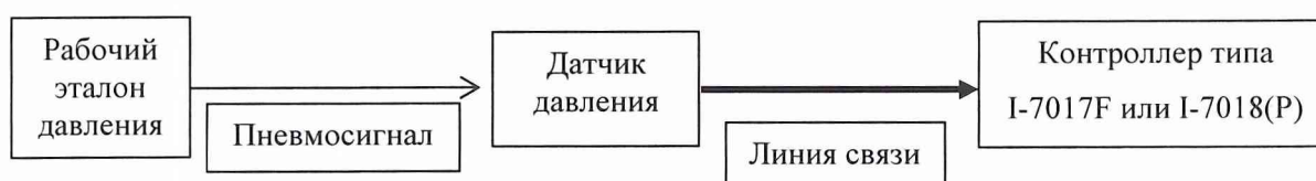
Рис.4. Схема подключения средств испытаний к ИК
