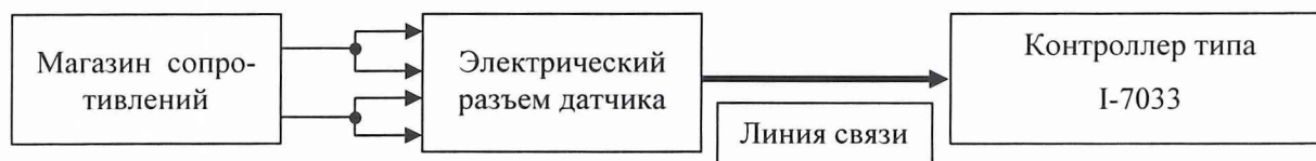
Рис.1. Схема подключения магазина сопротивлений к ИК
