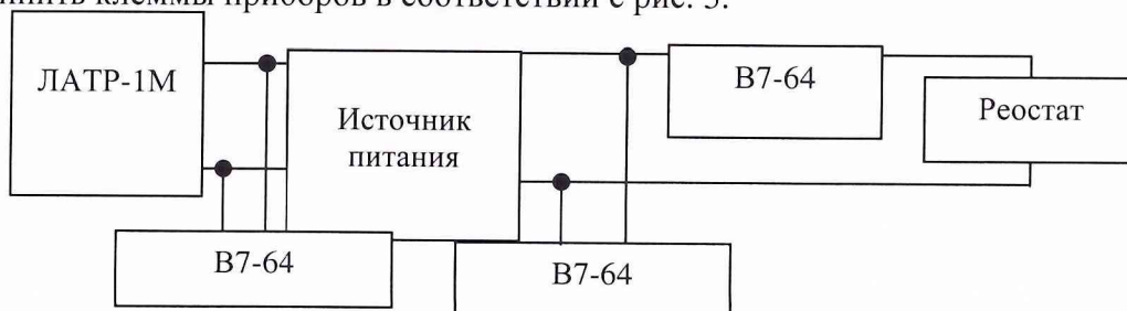
Рис. 3. Структурная схема соединения приборов при определении нестабильности выходного напряжения.
