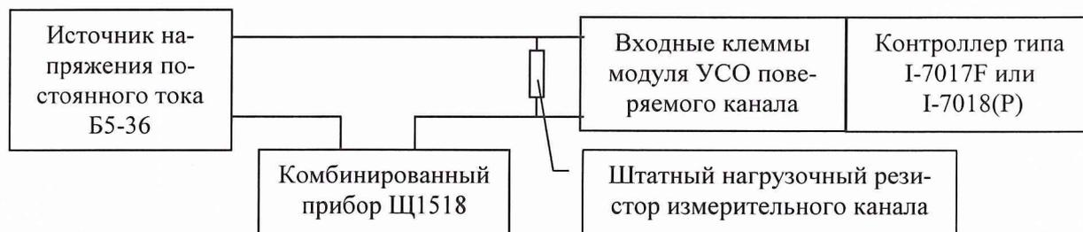
Рис.5. Схема подключения средств испытаний к ИК
