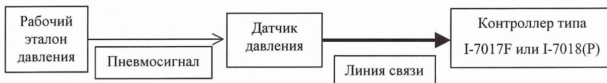
Рис.4. Схема подключения средств испытаний к ИК
