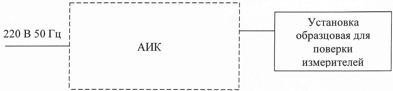
Рисунок 15 – Схема подключения для измерения КНИ
