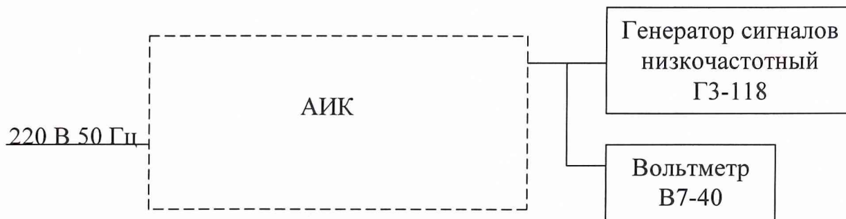
Рисунок 14 – Схема подключения для измерения напряжения частоты 1000 Гц
