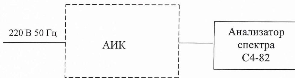
Рисунок 12 – Схема подключения для измерения уровня в.ч. сигнала
