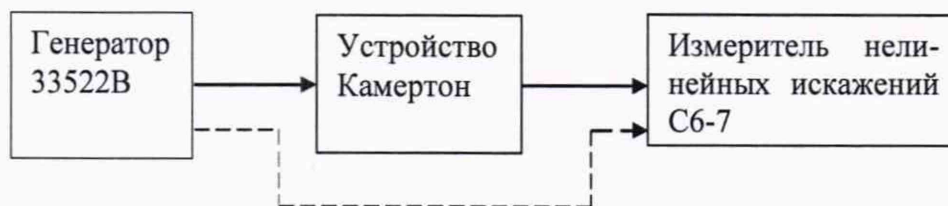
Рисунок 2. Проверка коэффициента нелинейных искажений в сквозном тракте "вход – выход"
