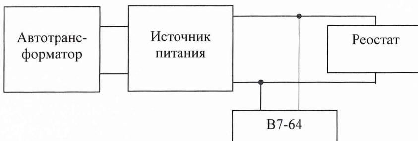
Рис. 3. Структурная схема соединения приборов при определении нестабильности выходного напряжения.
