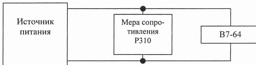
Рис. 2. Структурная схема соединения приборов при использовании метода косвенных измерений.
