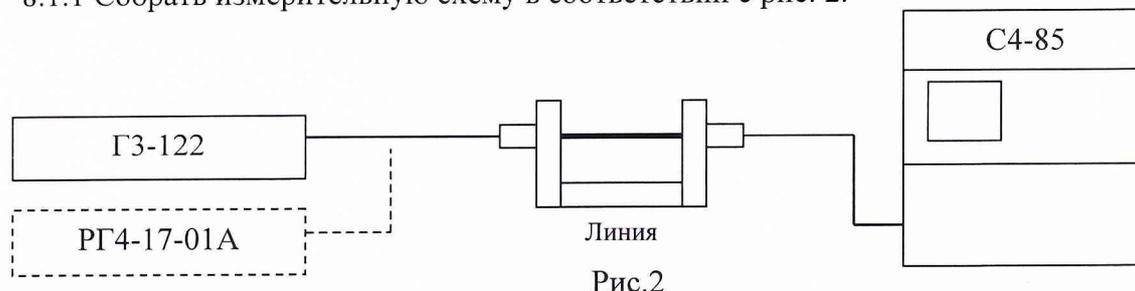
8.1.2 Установить на выходе генератора ГЗ-122 сигнал частотой 0,315 кГц с амплитудой 0,5 мВ.
