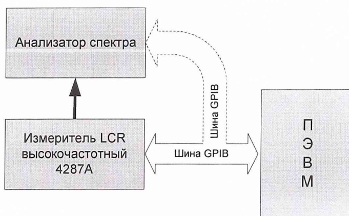
Рисунок 8.2 Определение погрешности воспроизведения мощности выходного измерительного сигнала с использованием анализатора спектра
