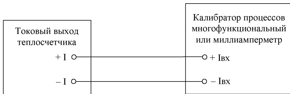
Рисунок Б.1 – Электрическая схема подключения эталонного СИ при поверке токового выхода теплосчетчика
