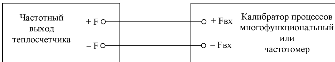
Рисунок Б.2 – Электрическая схема подключения эталонных СИ при поверке активного частотного выхода теплосчетчика.
