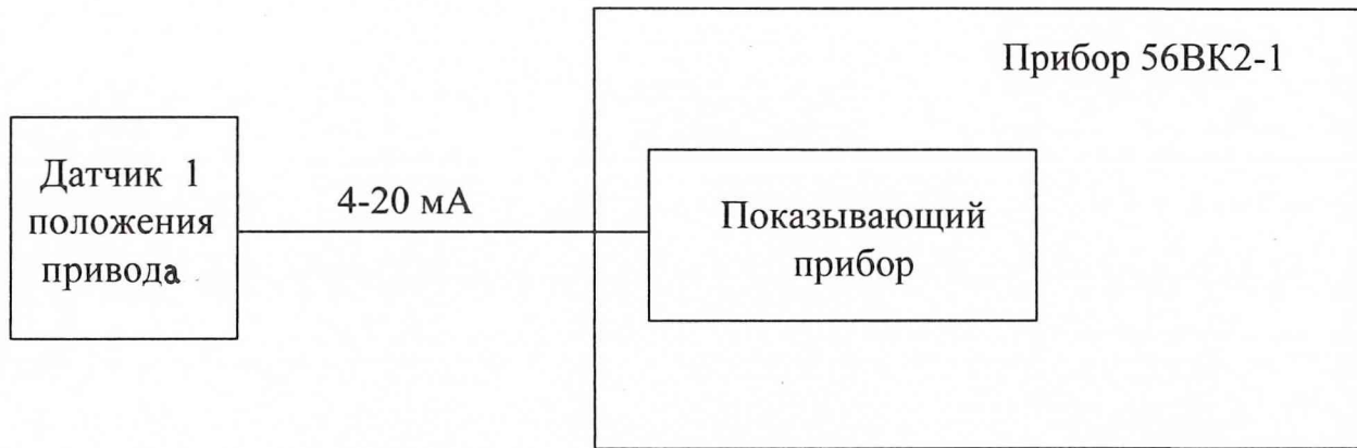
Рисунок 3 - Структурная схема ИК положения приводов с выводом на показывающие приборы.
