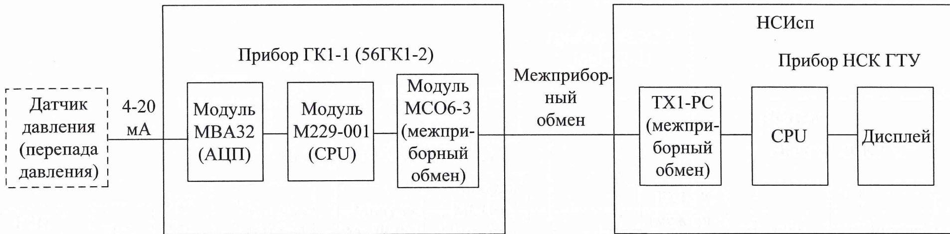
Рисунок 1 - Структурная схема ИК давления, перепада давления и частоты вращения ТНА с выводом на дисплей.
