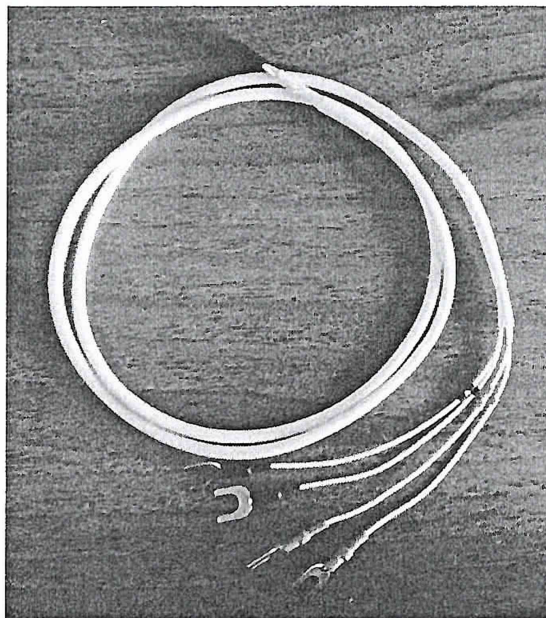
Рисунок 7 – Кабель для подключения магазинов сопротивления
