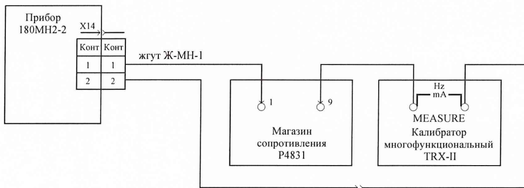
Рисунок 3 – Схема подключения испытательного оборудования
