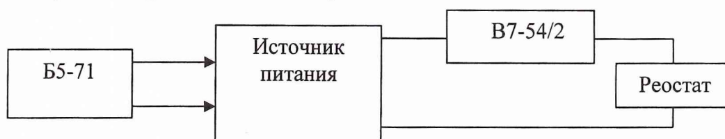
Рис. 7. Структурная схема соединения приборов при определении нестабильности выходного тока.
