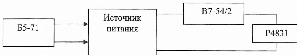
Рис. 5. Структурная схема соединения приборов при использовании метода прямых измерений.
