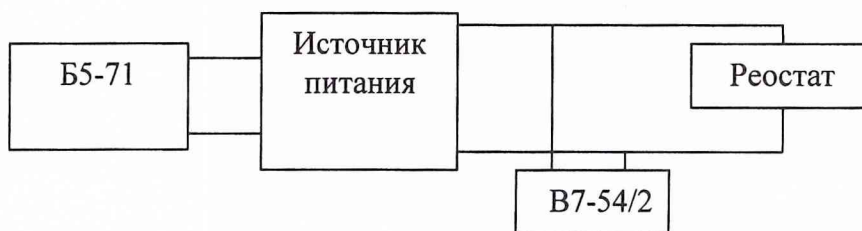
Рис. 6. Структурная схема соединения приборов при определении нестабильности выходного напряжения.
