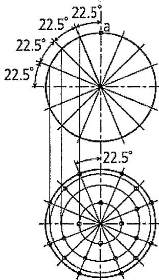
Рисунок 1. Точки касания на сфере для определения допускаемой абсолютной погрешности измерительной головки, МРЕ<sub>р</sub>
