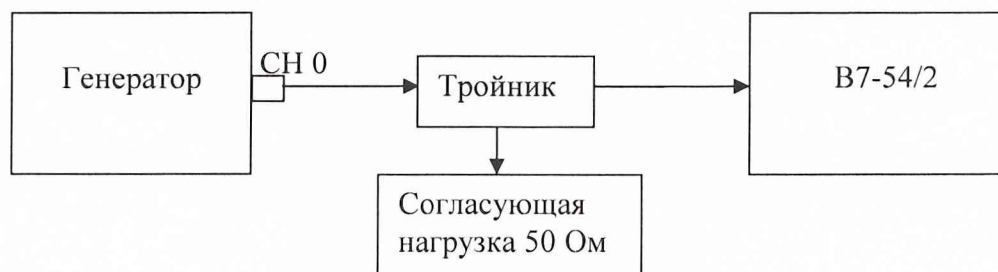
Рисунок 5 - Структурная схема соединения приборов при определении погрешности воспроизведения размаха амплитуды выходного синусоидального сигнала
