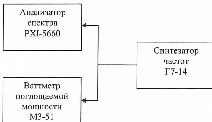
Рисунок 4 - Структурная схема соединения приборов при определении неравномерности АЧХ в полосе частот
