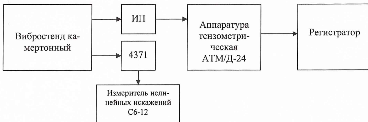
Рис.5а. Схема определения МХ ИК параметров удара (в диапазоне амплитуд свыше 300 м/с 2 ) для ИП типов АНЭ-211, АНЭ-211-02.
