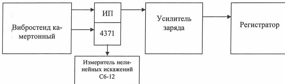
Рис.3. Схема определения МХ ИК вибрации (в диапазоне амплитуд выше 300 \text{ м/с}^2 ).
