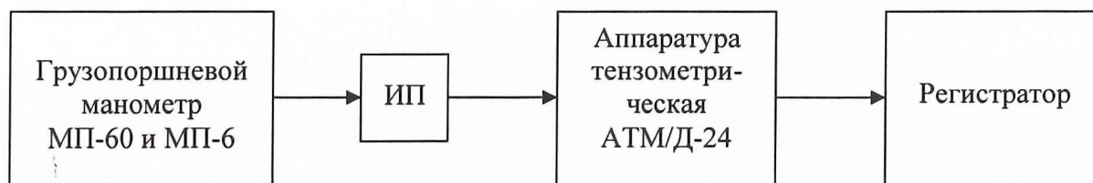
Рис.6. Схема определения МХ ИП избыточного и абсолютного давлений.
