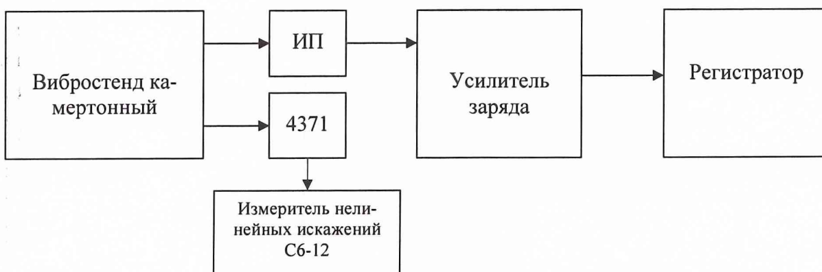
Рис.5а. Схема определения МХ ИК параметров удара (в диапазоне амплитуд свыше 300 м/с 2 ) для ИП типов АНЭ-211, АНЭ-211-02.
