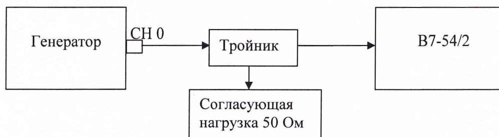
Рисунок 4 - Схема измерений пределов и погрешности установки уровня выходного напряжения синусоидального сигнала
