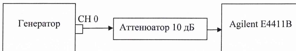
Рисунок 6 - Структурная схема соединения приборов при определении относительного уровня гармонических составляющих по основному тракту с высоким усилением
