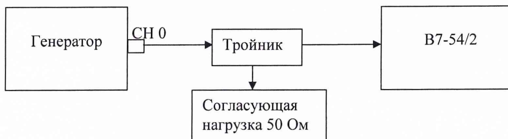
Рисунок 4 - Схема измерений диапазонов и погрешности установки уровня выходного напряжения синусоидального сигнала
